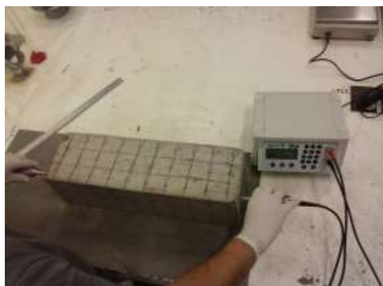
Figura 2. Leituras do pulso ultrassônico pelo método direto.
