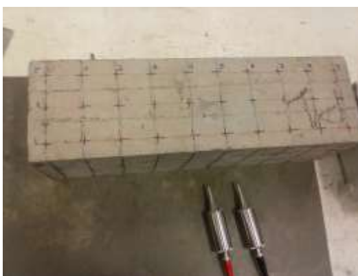
Figura 1. Malha em CP prismático para determinação do pulso ultrassônico.
