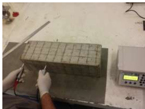
Figura 3. Leituras do pulso ultrassônico pelo método indireto.
