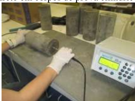
Figura 1 – Ensaio de ultrassom pelo método direto em corpos de prova cilíndricos
